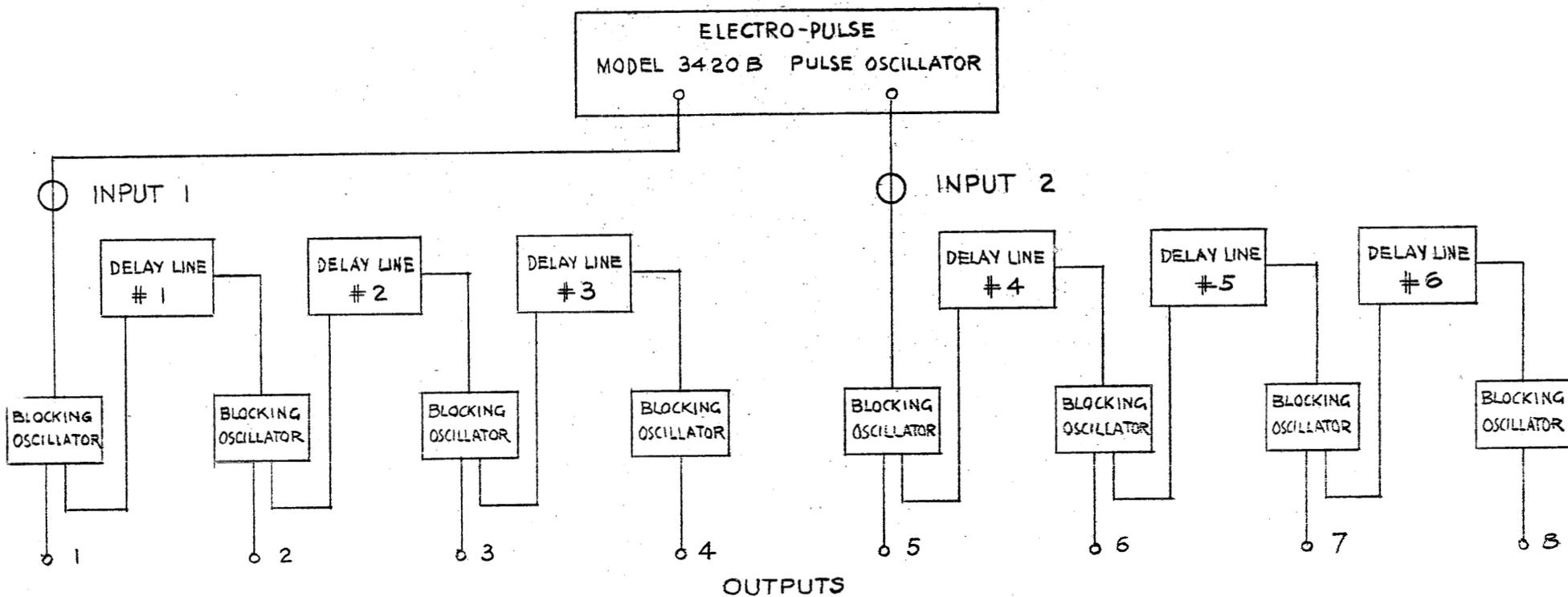
DELAY LINES: SHALLCROSS DELAY LINE
