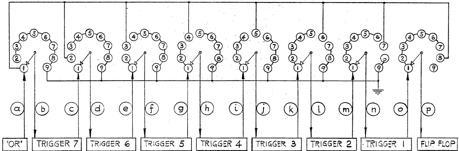
FIGURE 4E - CORE TESTER TRIGGER SELECTION SWITCH
