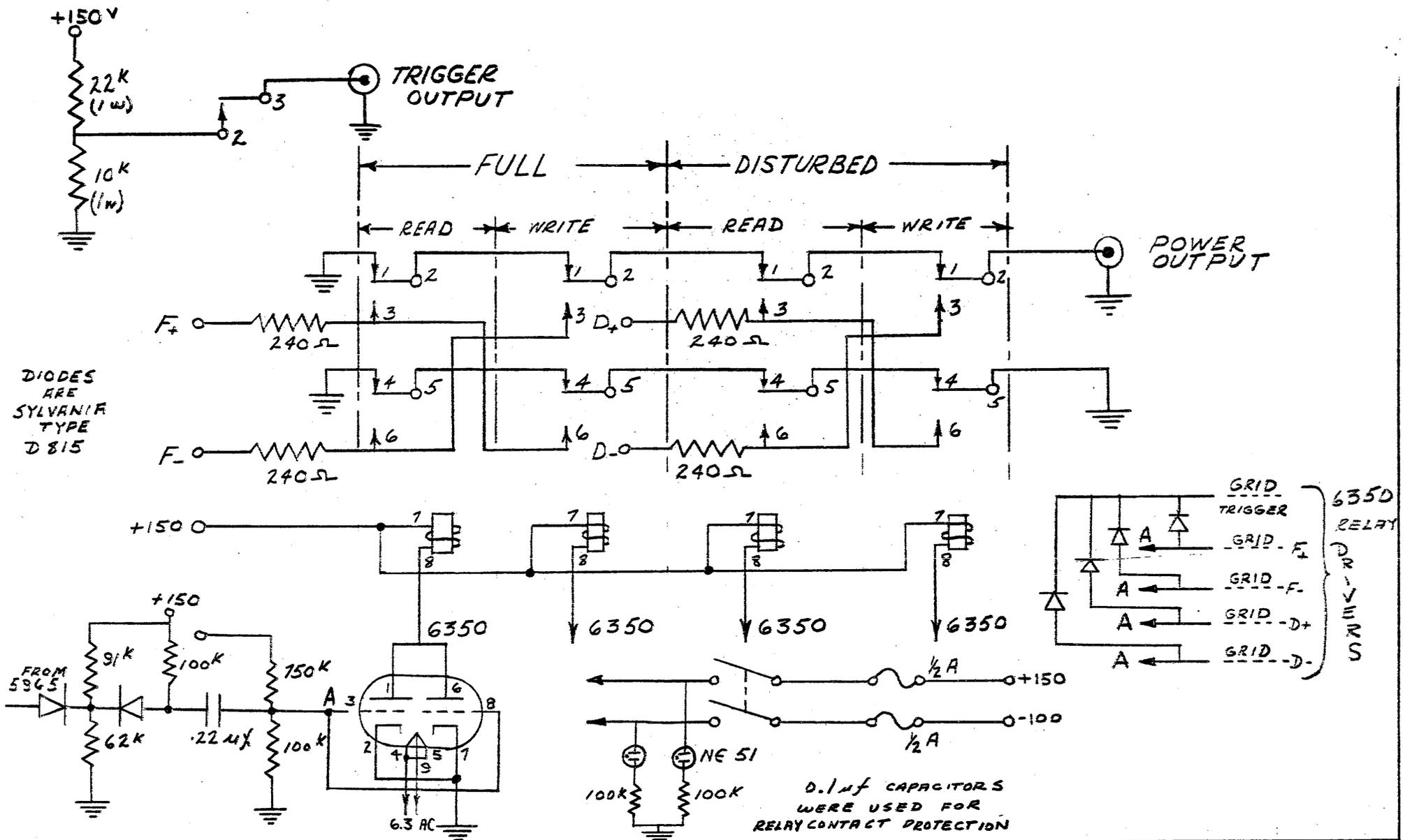
FIGURE 5E - CORE TESTER RELAY CIRCUITS
