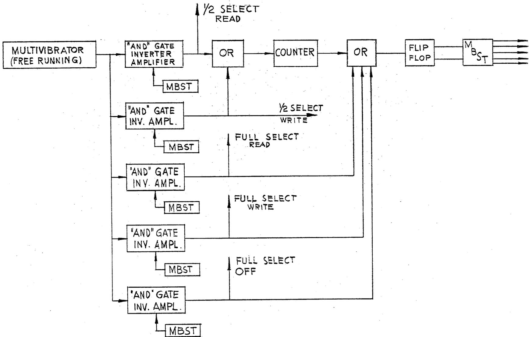
FIGURE 3E - BLOCK DIAGRAM OF CORE TESTER LOGIC CIRCUITS
