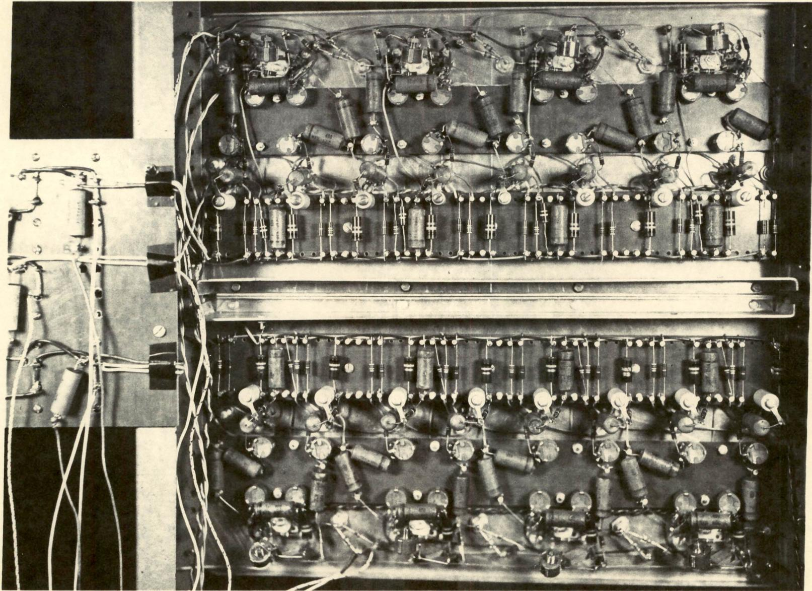
FIG.15 REAR VIEW OF ENCODER
