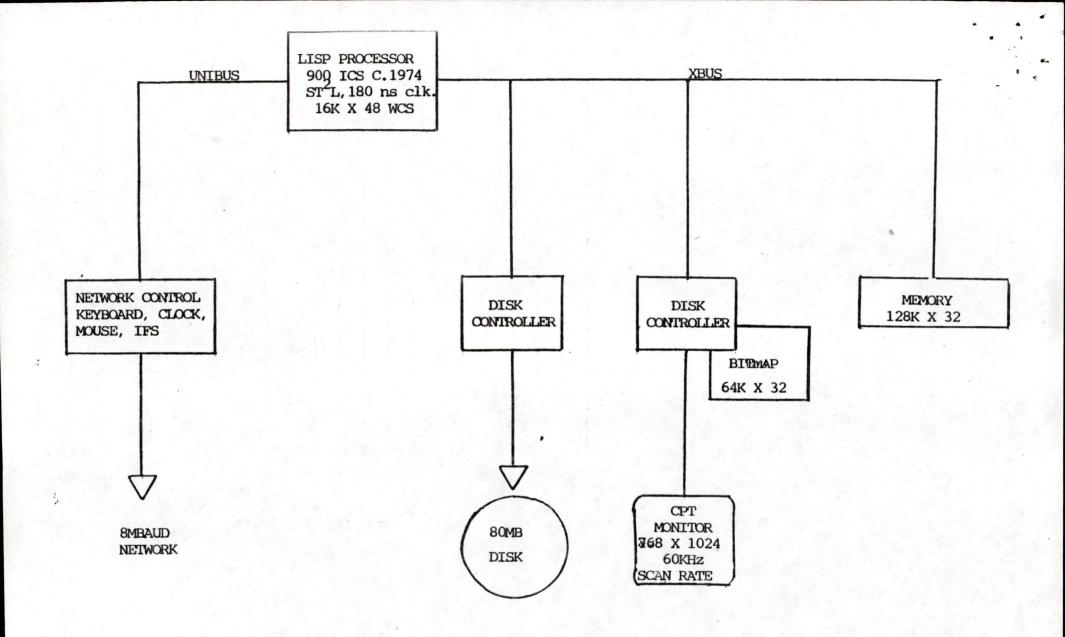
LISP MACHINE BLOCK DIAGRAM
