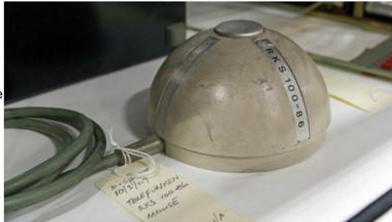
schwindigkeit der Rollkugel sich die Resolver um mehr als 360 Grad pro Datenabfrage drehten und damit die Codewerte mehrdeutig waren. Dies musste von dem Rechner erkannt und korrigiert werden, damit der Cursor auf dem Schirm keine Sprünge ausführte.
